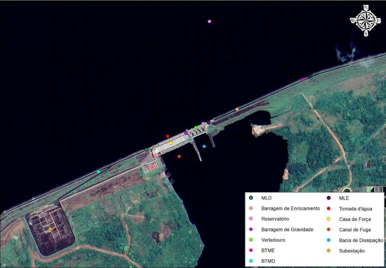
Figura 1.1: Arranjo geral das estruturas da UHE Balbina Fonte: SAS Planet, adaptado
